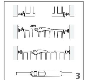
Wird das Gitter verschraubt, bohren Sie zunächst ein 6-mm-Loch in die Wand und setzen Sie den Wanddübel ein. Sichern Sie den Wandnapf anschließend mit der Schraube. Falls Sie in eine Gipsbauplatte bohren, sind Gipskartondübel (im Baumarkt erhältlich) zu verwenden. Sie können jetzt das Türschutzgitter wieder so, wie zuvor erläutert, einsetzen.
